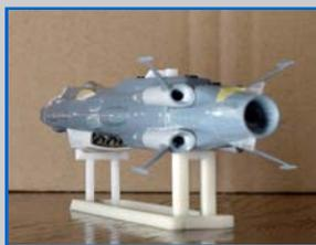
補助エンジンはプラペーパーを巻いて大型化し、ノズル追加の為開孔。
